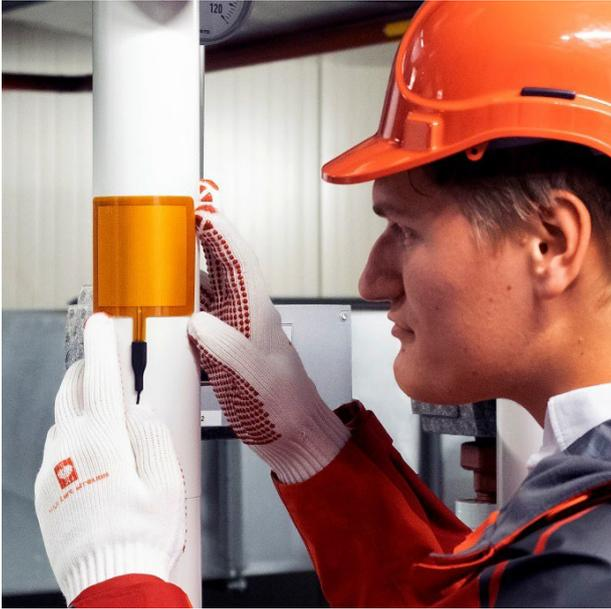
Figure 2 FHF05-85X85 用来测量管道上的热通量
